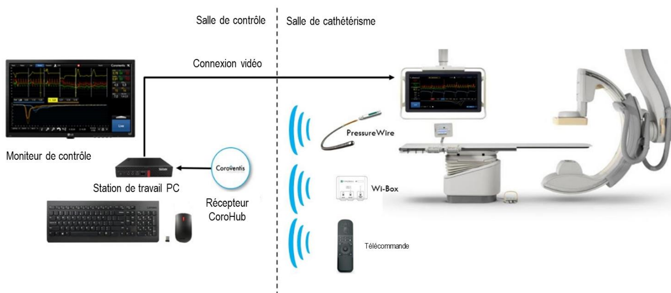
Figure 2. Intégration du système cardiovasculaire Coroventis CoroFlow MC en salle d'hémodynamie (adaptation du site de la compagnie, https://www.coroventis.com/coroflow/ )
