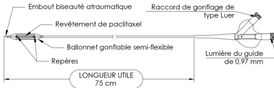
Figure 2. Représentation schématique du cathéter à ballonnet enduit de médicament Optilume®
